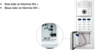
Die beiden freien MxBus-Klemmen des Kameramoduls können – alternativ zu den Klemmen am Zutrittsmodul oder Infomodul Mx2wire+ – zum Anschluss des MX-DoorMaster genutzt werden (siehe Abschnitt 2.5)
