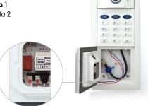
Entfernen Sie den blauen Blindstopfen am Modul. Führen Sie den RJ45-Stecker des (verlängerten) Kamera-Patchkabels ins Gehäuseinnere und stecken Sie ihn in die RJ45-Buchse ein. Bringen Sie den Gummidichtring am Patchkabel in seine korrekte Endposition.
