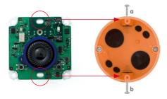
Alternativ wird das Gehäuse – wie bei einer Unterputzdose – mit vier oder zwei (diagonal gegenüberliegenden) Schrauben/Dübeln an der Wand festgeschraubt.
