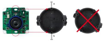
Das Gehäuse mit Platine wird mit vier oder zwei (diagonal gegenüberliegenden)
