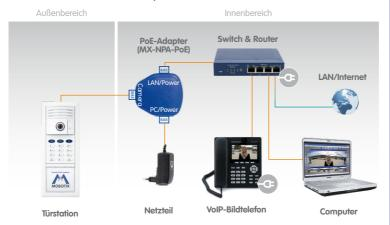
Die T25 (mit zusätzlicher PoE-Einspeisung z. B. durch den MOBOTIX PoE-Adapter) und ihre Gegenstellen können auch an einen vorhandenen WLAN-Router mit integrierter Switchfunktion (DSL-Box) angeschlossen werden
