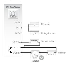
Der MX-DoorMaster verfügt über eine integrierte Relais-Funktion
