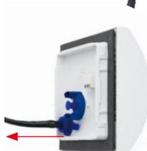
Längeres Patchkabel für das Infomodul Mx2wire+ anbringen
