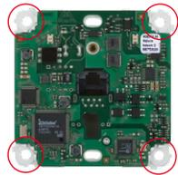
6. **Rahmen aufsetzen:** Gewünschten Rahmen (konkav, konvex oder plan) mit leichtem Druck auf die Platine aufsetzen, bis er automatisch einrastet. Der MOBOTIX Schriftzug am Rahmen befindet sich unten.
