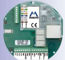
Alternativ kann die erweiterte IO-Anschlussplatine IO-Modul zum Anschluss externer Geräte (Klingel etc.) verwendet werden
