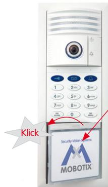
Modul immer so montieren, dass die Leiste mit **MOBOTIX** Schriftzug oben ist
