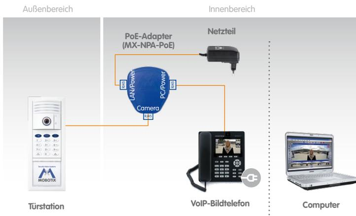
Der MOBOTIX PoE-Adapter (MX-NPA-PoE-SET) enthält eine Crossover-Funktion für den direkten Computer-Anschluss und kann entweder ans Stromnetz oder an andere Spannungsquellen von 12 bis 57 Volt angeschlossen werden
