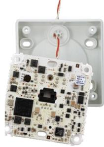
5. **Gehäuse mit Platine in Aufputzdose einsetzen:** Die beiden Kabelklemmen an der Rückseite des Gehäuses befinden sich oben. Das Gehäuse mit Platine wird über die vier vorgebohrten Löcher mit vier Edelstahlschrauben an der Aufputzdose befestigt.
