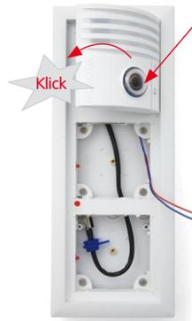
**Kontroll-Klick:** Wenn kein Klickgeräusch zu hören ist, ist das Modul nicht richtig eingerastet. Überprüfen Sie in diesem Fall die letzten Arbeitsschritte und achten Sie darauf, dass kein Kabel oder Fremdkörper im Gehäuse die Montage behindert.
