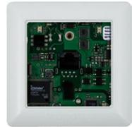
6. **Blende einsetzen:** Die Frontblende wird erst unten wie im Bild gezeigt eingehängt und dann aufgedrückt.
