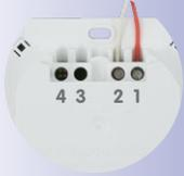
4. **Zweidrahtleitung an Klemme 1 und 2 anschrauben:** Es ist dabei unerheblich, ob ein Kabel an beiden Mx2wire+ Einheiten an der Klemme mit derselben Nummer angebracht ist oder nicht. Ein Vertauschen der Anschlüsse 1 und 2 beeinflusst die Funktion nicht.
