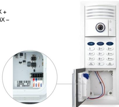
Die beiden freien MxBus-Klemmen des Kameramoduls können - alternativ zu den Klemmen am Zutrittsmodul oder Infomodul Mx2wire+ - zum Anschluss des MX-DoorMaster genutzt werden (siehe Abschnitt 2.5)
