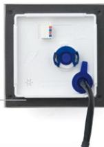
2. **Entfernen** Sie das **vormontierte Patchkabel** des Kameramoduls und stecken Sie dafür das mitgelieferte, **längere Patchkabel** ins Kameragehäuse. Bringen Sie den blauen Gummidichtring in seine korrekte Endposition.
