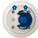
2. Schließen Sie das Sensorkabel an das Sensormodul an (blauen Bajonettverschluss nach links drehen und abnehmen, Stopfen entfernen, Sensorkabel einstecken, Bajonettverschluss wieder aufsetzen und nach rechts drehen). Stellen Sie sicher, dass die Sensorkabel im gesamten Verlauf nicht geknickt werden!
