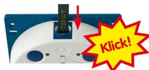
3. **MicroSD-Karte einsetzen:** Schieben Sie die MicroSD-Karte wie gezeigt (Kontakte in Richtung der Vorderseite) mit einer Pinzette in den Karteneinschub. Stellen Sie sicher, dass beim Einschieben ein **Klicken** zu hören ist. Die Karte ist jetzt verriegelt und kann verwendet werden. **Beim Verwenden einer neuen MicroSD-Karte muss diese zuerst formatiert werden** (siehe Abschnitt 3.5.2, «Formatieren der MicroSD-Karte»).
