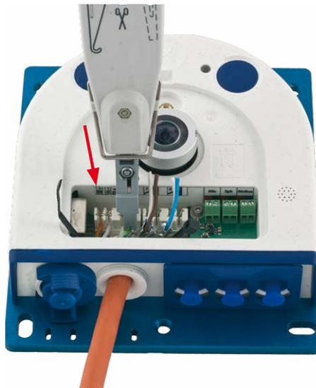
Falls zusätzliche Kabel im Inneren des Gehäuses (MxBus, Mikrofon, Lautsprecher) benötigt werden, sind diese wie in *Abschnitt 2.5.3, «Anschließen zusätzlicher Kabel»* beschrieben zu verbinden.
