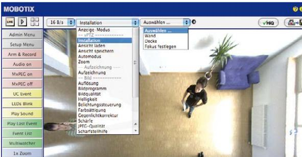
Wenn Sie eine S15D mit zwei Sensormodulen einrichten, legen Sie die Montageart jeweils getrennt im QuickControl-Feld **Installation (Rechts)** bzw. **Installation (Links)** für das rechte bzw. linke Sensormodul (Kamerabil) fest.
