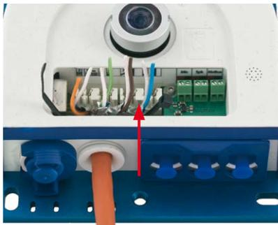
Darauf achten, dass das Verlegekabel bei fertig positionierter Kamera gerade in das Gehäuse hineinführt, damit der Kabelstopfen das Gehäuse optimal abdichtet.
