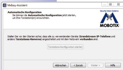
In diesem Fall führt der **MxEasy-Assistent** die Autokonfiguration durch und leitet Sie Schritt für Schritt durch die Konfiguration der angeschlossenen Module sowie der Klingelprofile, Mailboxen usw.
