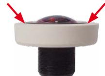
5. Drehen Sie das Objektiv mit Dichting mithilfe des blauen Modulschlüssels wieder hinein.
