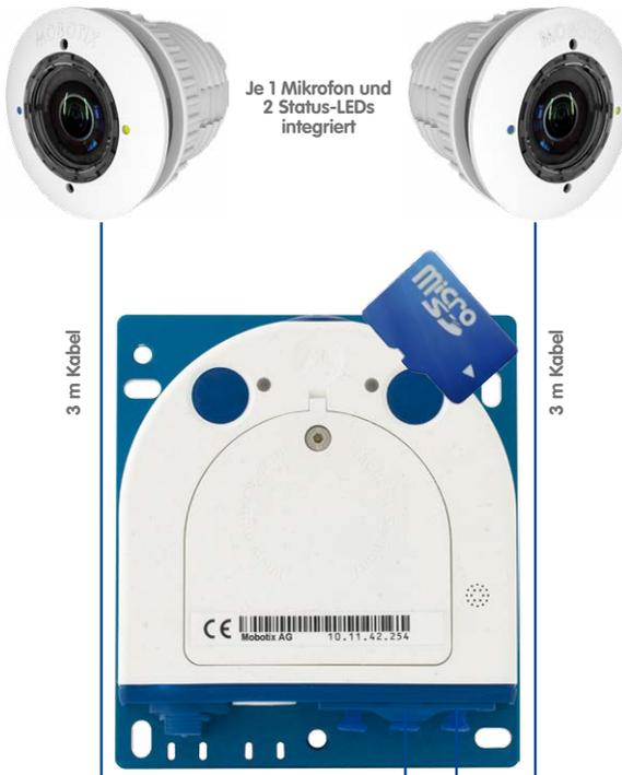
Die S15D kann mit bis zu zwei HiRes-Bildsensoren mit wahlweise 3072x2048 (6MP) bzw. 2592x1944 (5MP) Pixeln betrieben werden und liefert so ein bis zu 12 Megapixel großes Farb-Doppelbild beider Bildsensoren gleichzeitig auf den Monitor. Das System kann mit beliebigen Kombinationen aus Tag-, Nacht-, Nacht-LPF-, Thermal oder BlockFlexMount-Sensormodulen bestückt werden. Die maximale Bildrate beträgt auflösungsabhängig bis zu 30 Bilder pro Sekunde.
