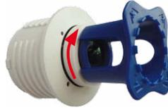
6. Justieren Sie die Bildschärfe anhand des Kamera-Livebilds am Monitor: Drehen Sie hierzu das Objektiv mit dem blauen Modulschlüssel vorsichtig nach rechts oder links. **Schrauben Sie das Objektiv nicht zu weit hinein und wenden Sie auf keinen Fall Gewalt an, um Beschädigungen des Bildsensors zu vermeiden!**
