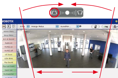
Details und Funktionsweise der Panorama- und Horizontkorrektur (Bild entzerren und waagrecht stellen) siehe Abschnitt 3.5
