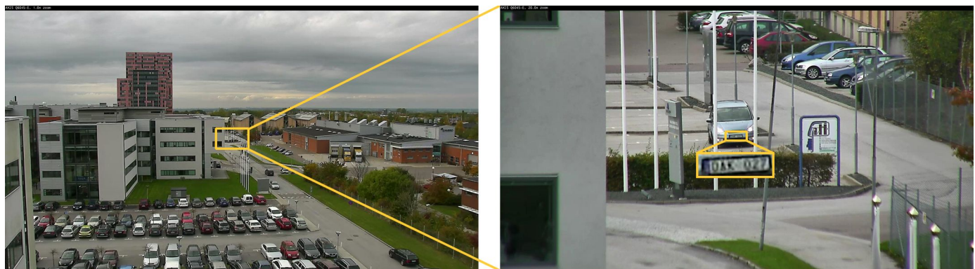
Schnappschüsse von HDTV 1080p-Ansichten der AXIS Q6045-E: links Weitwinkelansicht; rechts 20x Zoomansicht mit Nummernschild eines Fahrzeugs, das in 275 m Entfernung gelesen werden kann.
