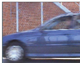
Zeilensprungverfahren, 20 ms Intervall zwischen Zeilen mit ungerader und gerader Zählung
