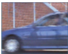
Zwischenzeilenabtastung, 20 ms Intervall zwischen Zeilen mit ungerader und gerader Zählung
