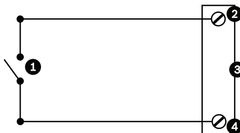
Bild 11.4: N.O. (Schließer) - Anschlüsse für nicht überwachten Schließeralarm
