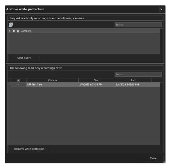
Abb. 35: Schreibschutz von Aufzeichnungen mehrerer Kameras entfernen
