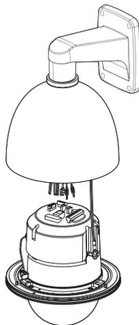
5. Alinee los orificios del cuerpo de la cámara y la carcasa y gírelos ligeramente.
