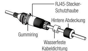
5. Montieren durch Drehen der RJ45-Schutzhaube und der hinteren Abdeckung im Uhrzeigersinn (dem Pfeil folgen). e hintere Abdeckung montiert, wird die wasserfeste Dichtung des Kabels fest an dem Kabel angebracht, damit das Kabel wasserdicht ist.
