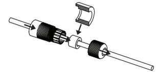
2. Verbinden Sie den LAN-Stecker mit dem Kabel.
