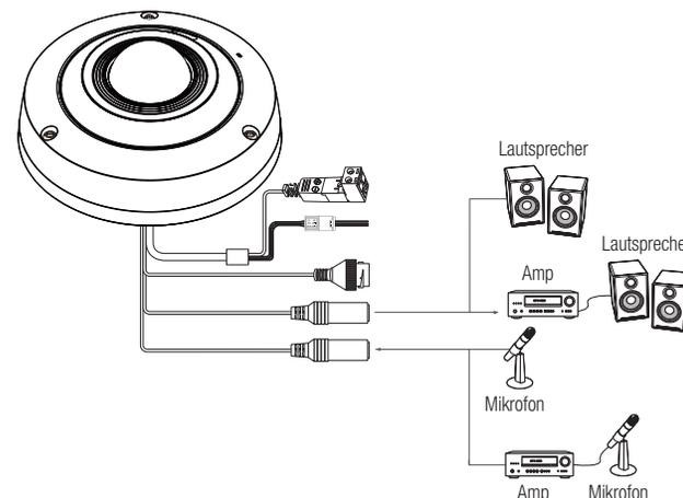
1. Verbinden Sie den AUDIO IN Anschluss der Kamera mit dem Mikrofon oder dem LINE OUT Anschluss des Verstärkers, an den das Mikrofon angeschlossen ist.
