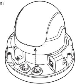
3. Stecken Sie das Netzkabel in das kleine Loch, indem Sie das herausragende Teil des Gummistopfen, wie in Schritt 2 entfernen, und legen das Kabel entlang der langen Kerbe.
