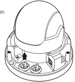
3. Fügen Sie das Alarm-/Audiokabel durch das Loch, das durch Entfernen der Gummikappe in Nr. 2 entsteht. Verbinden Sie das Kabel zum Alarmanschluss.
