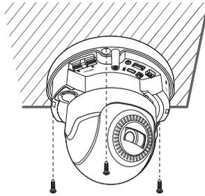
3. Richten Sie das Loch für die Kamerainstallation mit dem Loch aus, in das der Kunststoffanker eingesetzt werden soll, und befestigen Sie die Kamera mit Hilfe der Schrauben.
