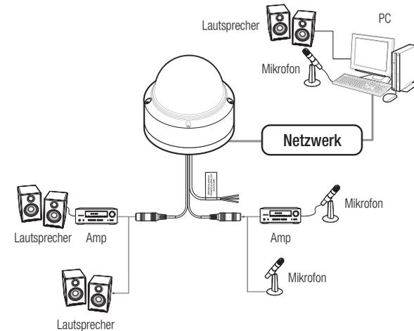
1. Verbinden Sie den AUDIO IN Anschluss der Kamera mit dem Mikrofon oder dem LINE OUT Anschluss des Verstärkers, an den das Mikrofon angeschlossen ist.
