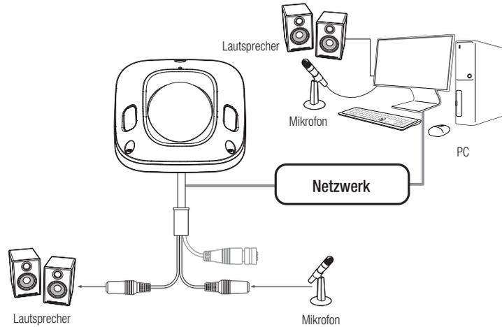
1. Verbinden Sie den MIC Anschluss der Kamera mit dem Mikrofon oder dem LINE OUT Anschluss des Verstärkers, an den das Mikrofon angeschlossen ist.
