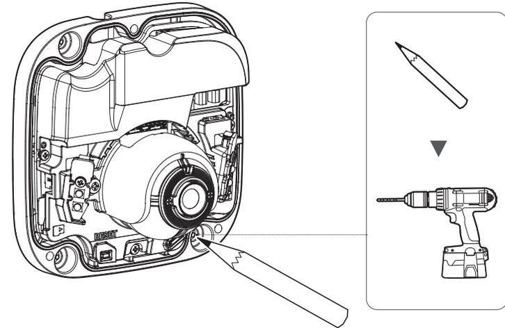
2. Befestigen Sie das Kameragehäuse mit geeigneten Schrauben.
