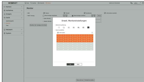
1. Wählen Sie **<Diese Anzeigen erweitern>** für die Videoanzeige und klicken Sie auf **<Setup>**. Sie können das Layout des erweiterten Monitors ändern.
