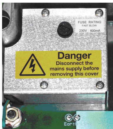
Bild 4.3 Abschirmung für Klemmenleiste (Hochspannungseingang) im Netzteilgehäuse
