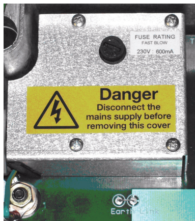
Bild 3.3 Abschirmung für Klemmenleiste (Hochspannungseingang) im Netzteilgehäuse
