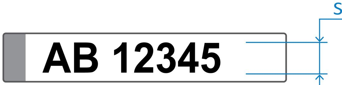
Eine Zeichenhöhe von 16 Pixeln im verarbeiteten Bild gilt als die optimale Pixeldichte. Nummernschilder mit kleineren Zeichenhöhen, wie z. B. 10 bis 12 Pixel pro Zeichen in rauschfreien Bildern, können von der Anwendung noch erkannt werden.
