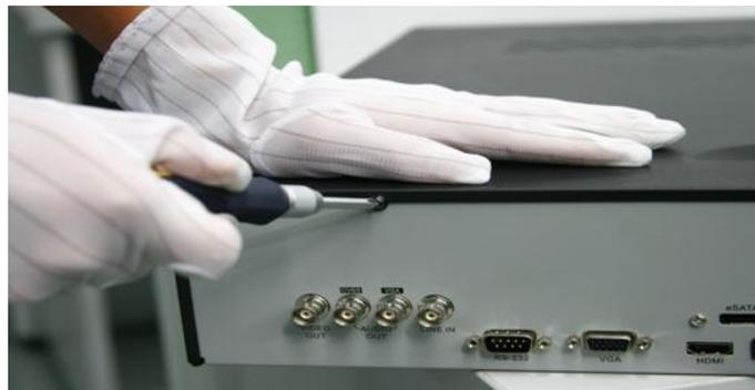
2. Installieren Sie unter Verwendung der mitgelieferten Schrauben die HDD in der vorgesehenen Halterung. Schrauben Sie die HDD am Boden fest.
