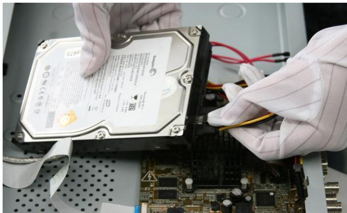
4. Schrauben Sie die HDD am Geräteboden fest.
