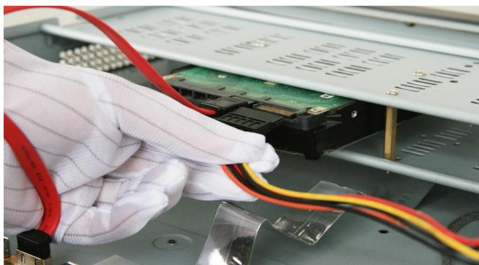
5. Bringen Sie die Abdeckung wieder am NVR an und ziehen Sie die Schrauben fest.
