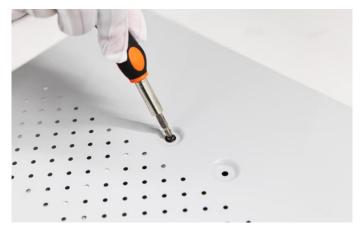
5. Bringen Sie die Abdeckung wieder am NVR an und ziehen Sie die Schrauben fest.
