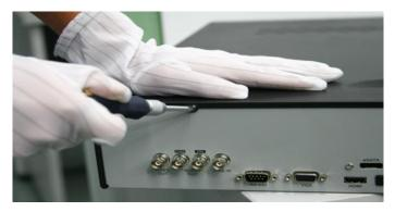
**2.** Installieren Sie unter Verwendung der mitgelieferten Schrauben die HDD in der vorgesehenen Halterung. Schrauben Sie die HDD am Boden fest.
