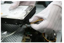
3. Schlie ßen Sie das Stromversorgungskabel an der HDD an.
