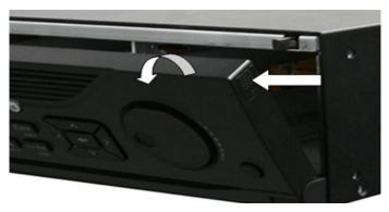
4. Schieben Sie die HDD vollst ändig in den Steckplatz.
