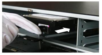
5. Wiederholen Sie die Schritte oben, um weitere HDDs im NVR zu installieren. Nachdem alle HDDs eingesetzt sind, schlie ßen Sie die Frontblende wieder und verriegeln sie.
