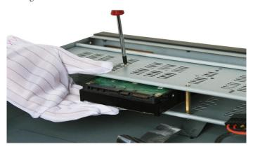
Schließen Sie ein Ende des Datenkabels an der Hauptplatine des NVR und das andere Ende an der HDD an.
